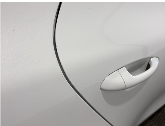
13: Door osr Chipped Edge Chip
