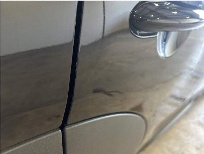
3: Door osr Chipped Edge Chip
