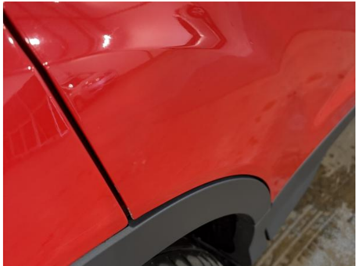
12: Door osr Chipped Edge Chip
