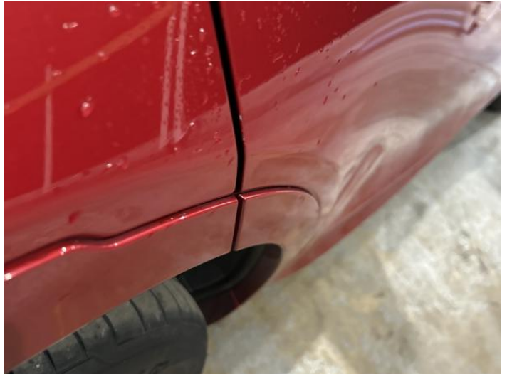
4: Door osr Chipped Edge Chip
