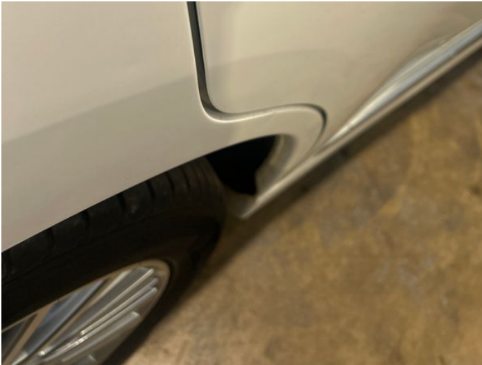
3: Door osr Chipped Edge Chip
