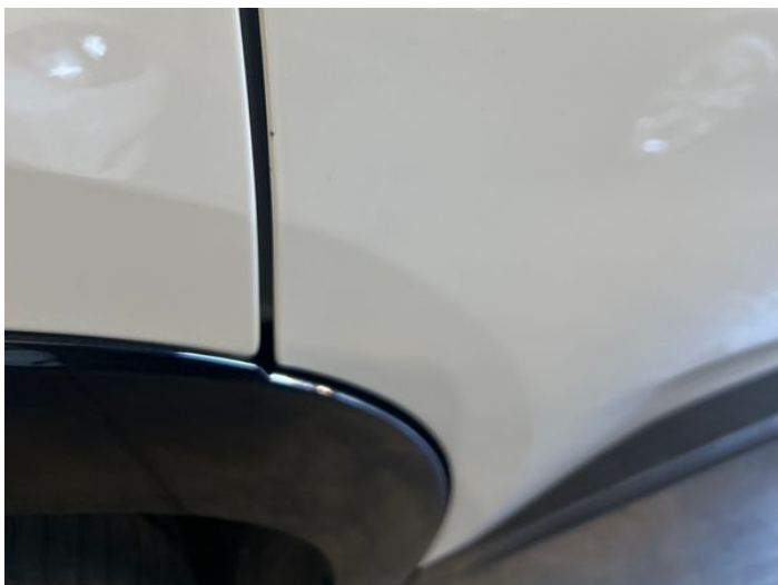
3: Door osr Chipped Edge Chip
