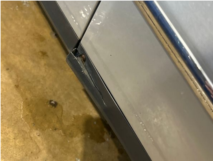
3: Door Moulding osf Broken Replace
