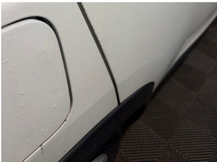
15: Door osr Chipped Edge Chip
