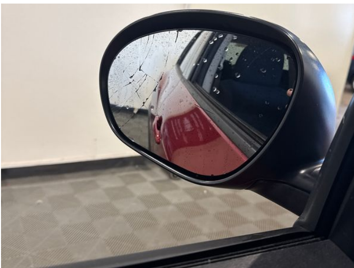
19: Door Mirror Glass ns Broken Replace
