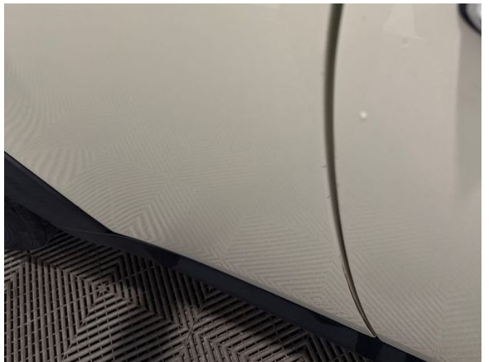
12: Door osr Chipped Edge Chip
