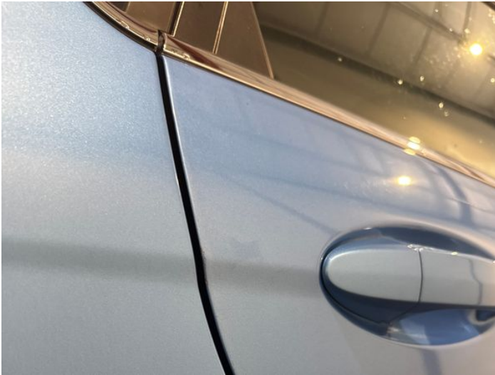
15: Door osr Chipped Edge Chip
