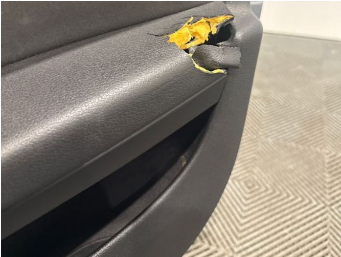
21: Door Pad osf Broken Replace
