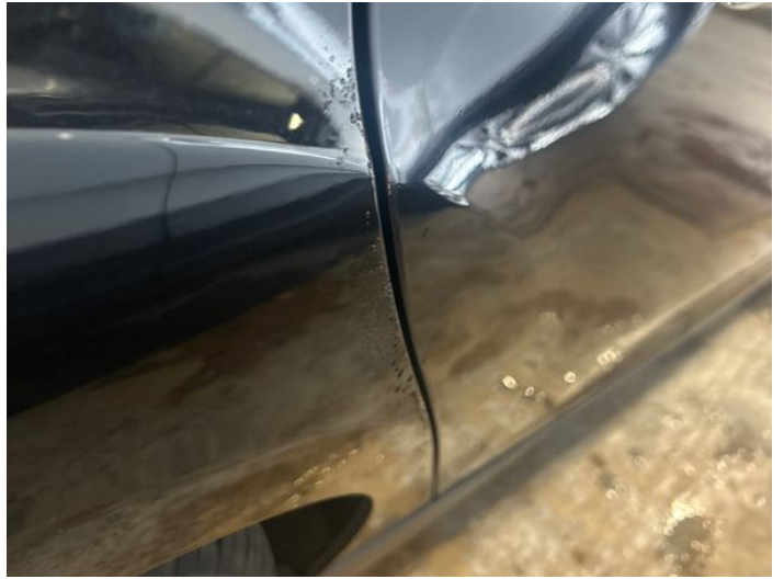
4: Door osr Chipped Edge Chip
