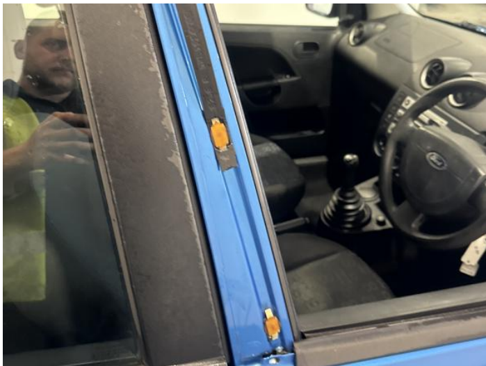
15: Door Moulding osf Missing Replace
