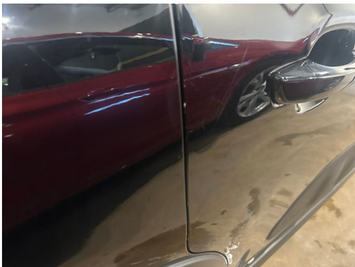
3: Door osr Chipped Edge Chip
