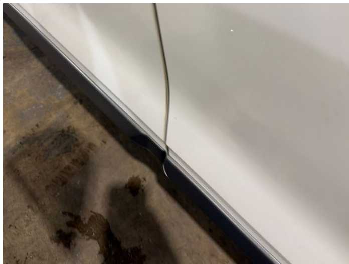
2: Door osr Chipped Edge Chip
