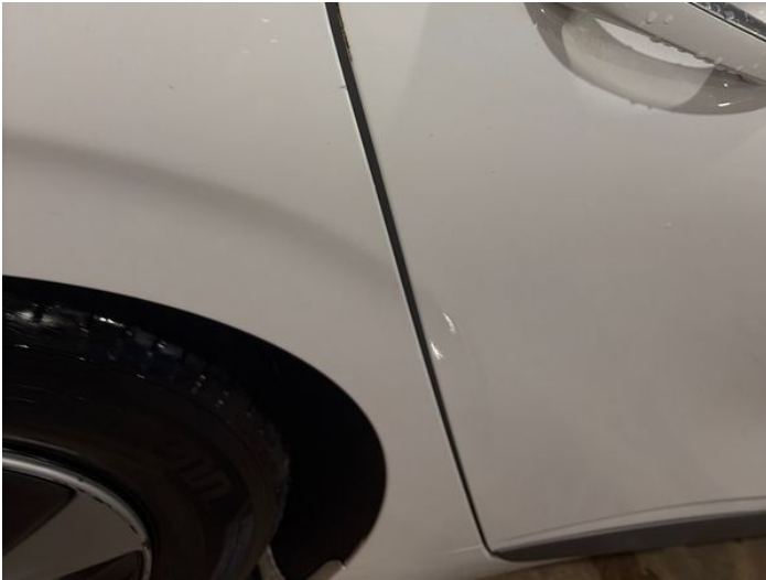
3: Door osr Chipped Edge Chip
