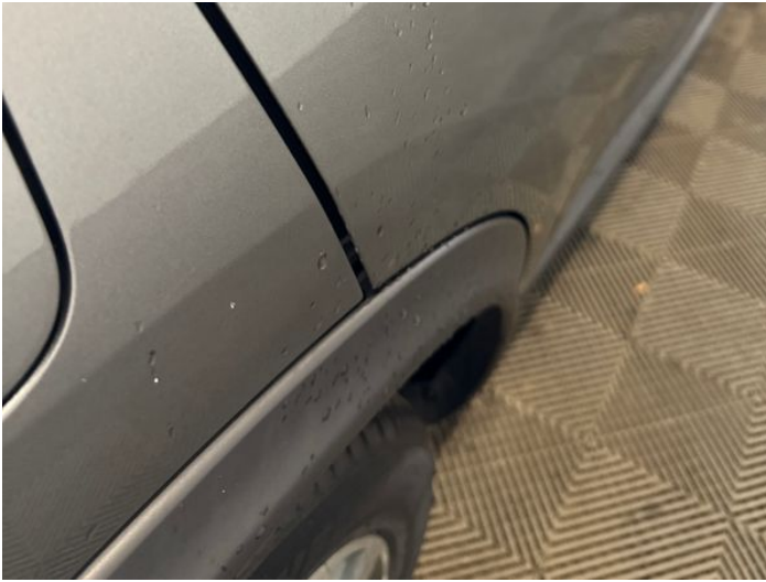
15: Door osr Chipped Edge Chip
