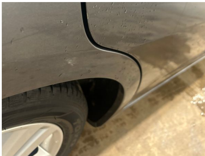
2: Door osr Chipped Edge Chip
