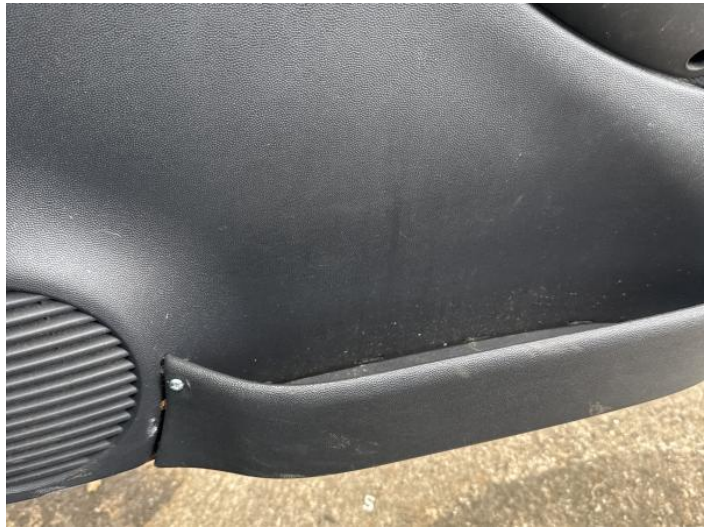
24: Door Pad osf Broken Replace
