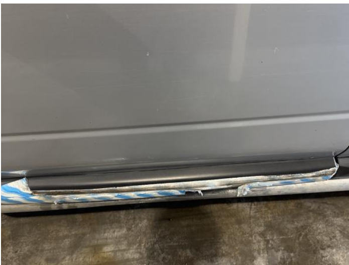
19: Door Moulding nsf Broken Replace
