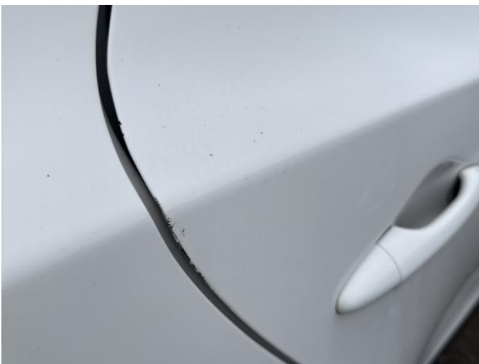
13: Door osr Chipped Edge Chip
