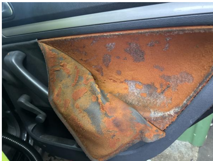
2: Door Pad osr Torn Over 10mm
