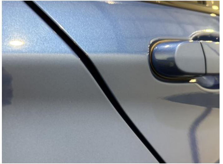
10: Door osr Chipped Edge Chip
