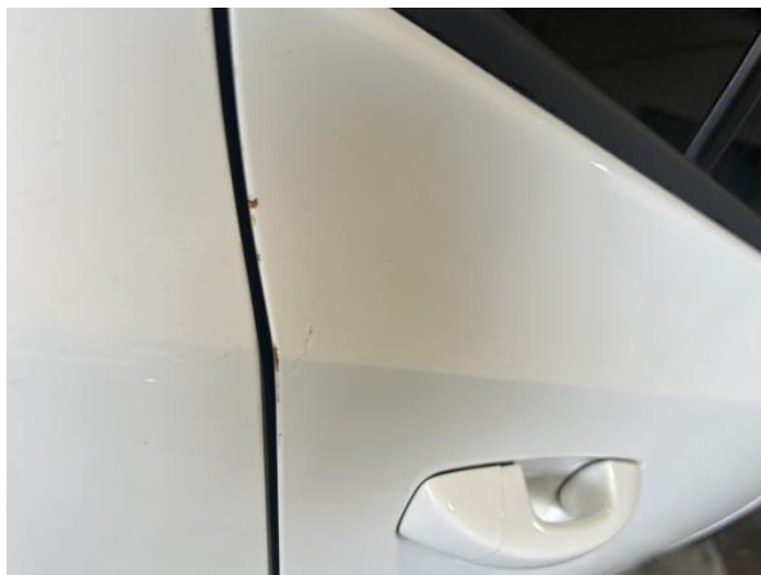
4: Door osr Chipped Edge Chip
